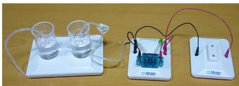
Πειραματική διάταξη παραγωγής ηλεκτρισμού με χρήση κυψέλης υδρογόνου
